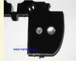
Placa de bază a senzorului de lumină (A4638200411, nu se mai livrează, Hella, 9XB736 930-00) are pe spate două fâșii de lipici transparent cu care este lipită de parbriz. Eu am desfăcut o dată placa.
