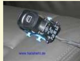
Pentru acționarea ferestrei se leagă din nou cablul cu comutatorul. (Cheia de contact scoasă !)
