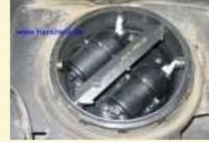
Două cremaliere albe din plastic așezate sub un unghi de 90° transmit bidimensional mișcările celor două motoare la inelul de plastic și implicit la oglindă. Printr-un suport mobil (săgeata galbenă) inelul din plastic este legat ca un balansoar de unitatea de reglaj care este prinsă cu șuruburi de spatele oglinzii.
