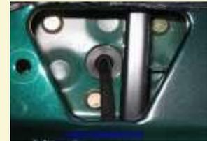
Pentru demontarea oglinzii exterioare complete trebuie scoasă căptușeala ușii (vezi Tipp 61a: Căptușeala ușilor 463) pentru a ajunge la cele trei șuruburi. În prealabil se coboară geamul lateral.
