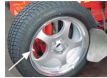
Abdrückschaufel in richtiger Position, das heißt nicht im Bereich des Ventils; eine Beschädigung der Radelektronik ist so ausgeschlossen.
