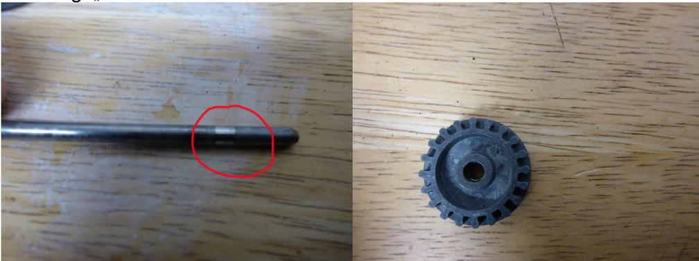
Über die Jahre hat das graue Aluzahnrad die Welle mit ihrem eingebauten Federring blankgedreht, so dass das graue Zahnrad nicht mehr angetrieben wird und das Zählwerk dadurch nicht mehr funktioniert.
