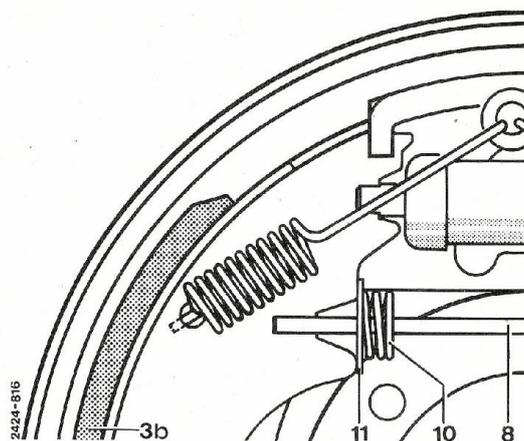
**Hinweis:** Werden die Bremsbacken nur aus montagebedingten Gründen abgenommen, dann weder automatischen Nachsteller lösen noch die Nachstellschrauben verdrehen, da sonst eine Neueinstellung der Bremse erfolgen muß.
