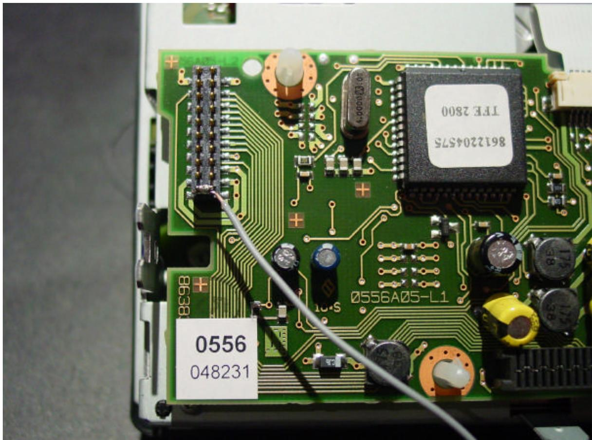
Als nächstes das Display wieder am Comand Montieren und das Kabel nach unten zur Platine durchführen und an Rot markierten Punkt anlöten:
